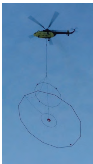
Рис. 5. Отбор мелкообъёмной пробы с применением минидраги (а) и комплексная аэрогеофизическая съёмка VTEM+ (магнитный + электроразведочный каналы) (б).
