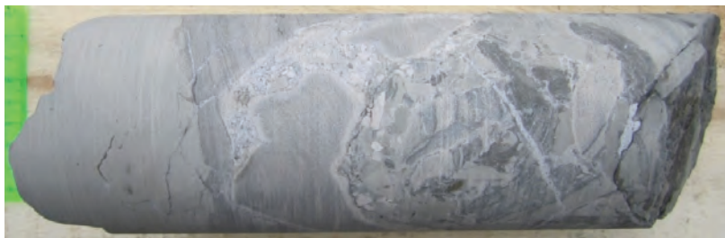
Рис. 7. Брекчия флюидоразрыва с карбонатными обломками с каймами осветления и кальцитом. Присутствует мелкозернистый пирит. Сква. 504-1, глубина 152,7 м.
