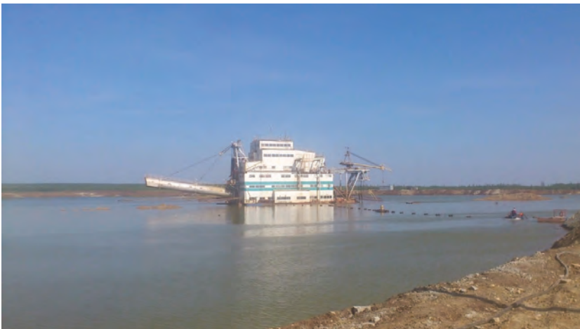
Рис. 7. Отработка россыпного месторождения «Горное» с использованием драги.
